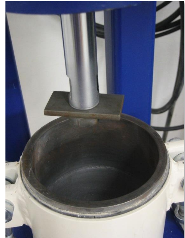
Prüfgerät zur Durchführung des LCPC-Versuchs: links: Übersicht über den Versuchsapparat, rechts: Blick in den Verschleißtopf mit Prüflügel
