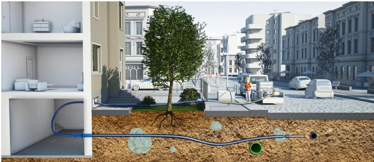
Bild 1: Hawle NoDig System - Funktionsprinzip
