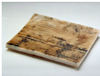
Bild 1: Probestück – ältester Liner der Welt nach 25 a in Betrieb
