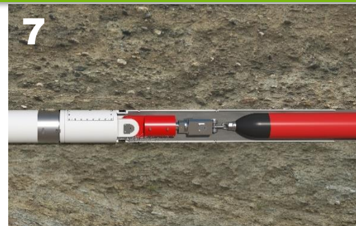
7 Einzug der Kabelschutzrohre durch Rückzug des Rohrstrangs
