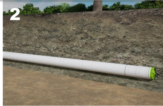
2 Bodenabbau mit AVNS und Vorschub mit temp. Rohren
